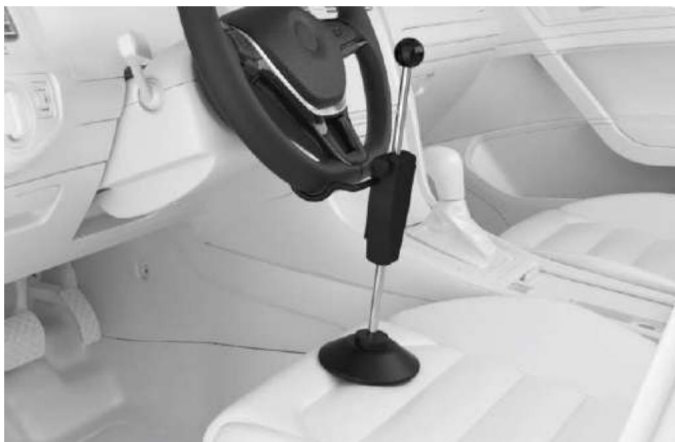
Figura 6-43 Instale la herramienta de soporte del volante
