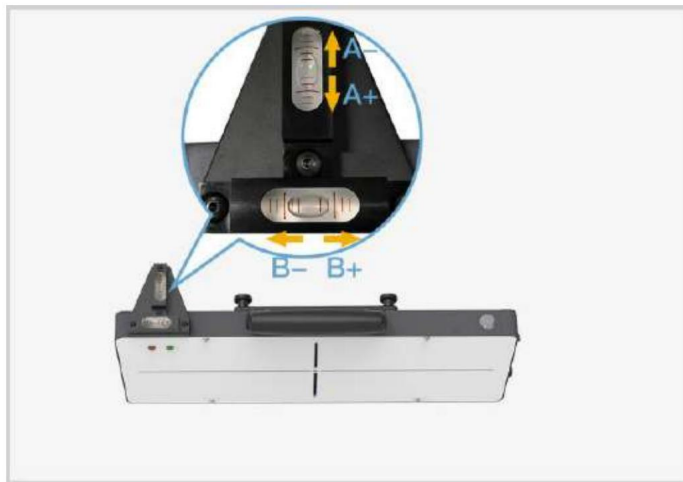
Figura 6-103 Centre la burbuja en el nivel de burbuja
