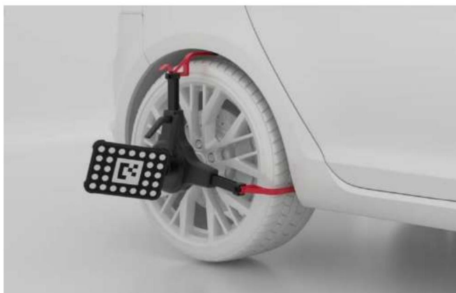
Figura 6-137 Instale las abrazaderas de las ruedas (abrazaderas para neumáticos) y los objetivos
