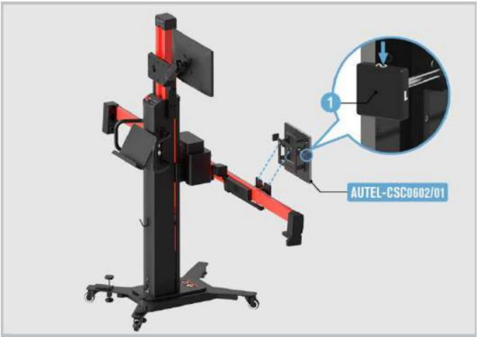
Figura 6-8 Ajuste del reflector 1
