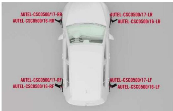
Figura 6-45 Instalación de abrazaderas de ruedas (abrazaderas para neumáticos) y objetivos
