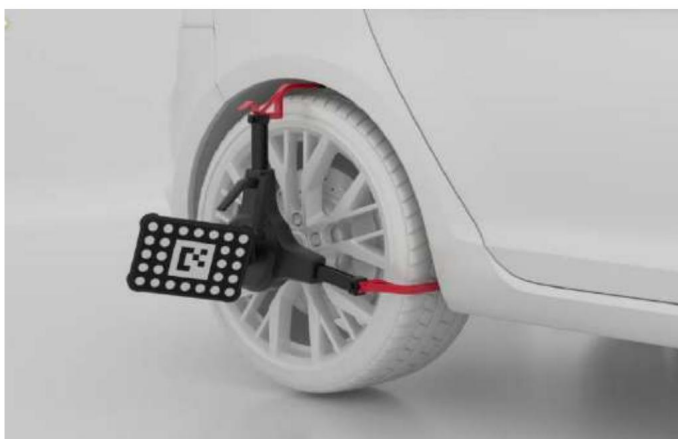
Figura 6-96 Instale las abrazaderas de las ruedas (abrazaderas para neumáticos) y los objetivos
