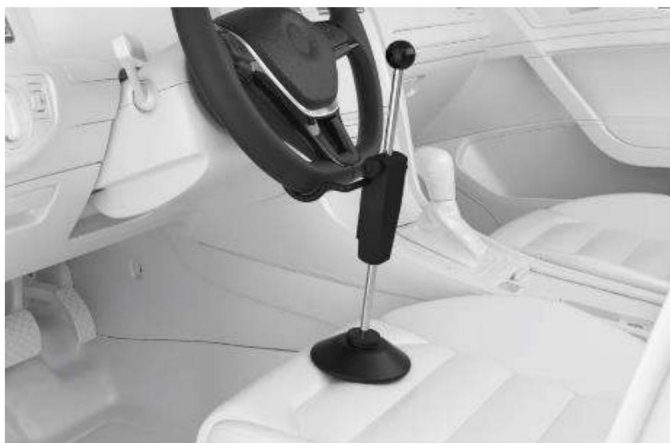
Figura 6-147 Instale la herramienta de soporte del volante
