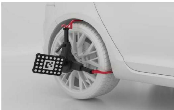
Figura 6-109 Instale las abrazaderas de las ruedas (abrazaderas para neumáticos) y los objetivos
