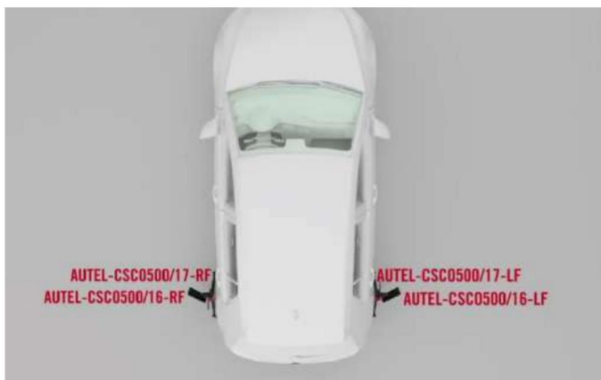
Figura 6-31 Instale las abrazaderas de las ruedas (abrazaderas para neumáticos) y los objetivos
