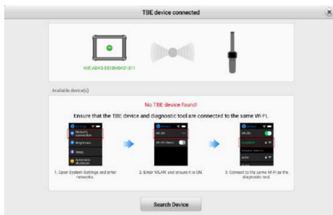
Figura 4-21 Conectar con el dispositivo MaxiTPMS TBE 1
