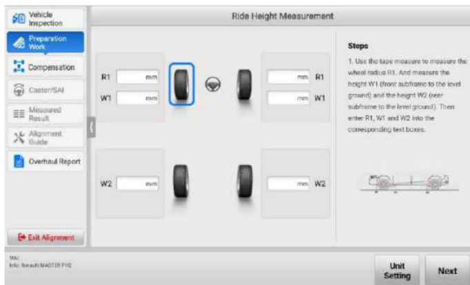
Figura 4-31 Medir la altura del vehículo con cinta 2
