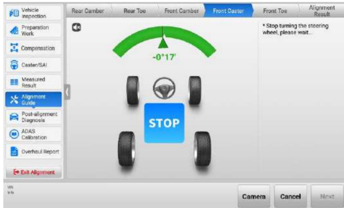
Figura 4-70 Ajuste del volante
