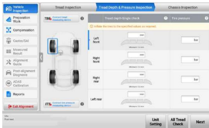
Figura 4-15 Pantalla de inspección de presión y profundidad de la banda de rodadura 1
