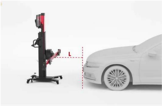
Figura 6-64 Centrar el marco de calibración
