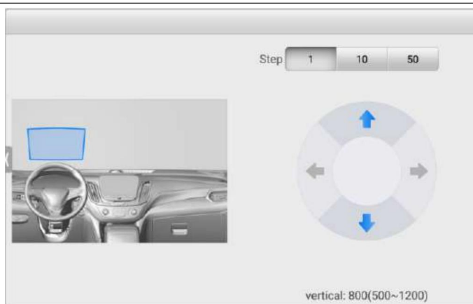
Figura 6-90 Corrección de imagen del HUD
