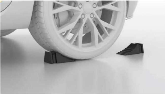
Figura 6-42 Coloque los calzos de las ruedas
