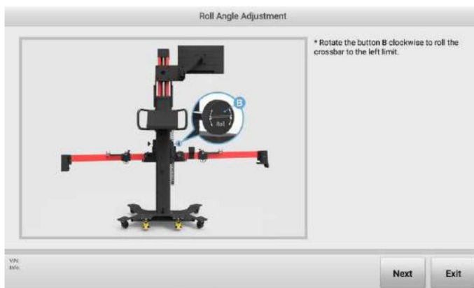
Figura 5-57 Ajuste del ángulo de balanceo 1
