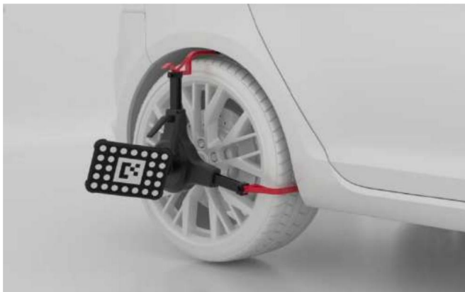
Figura 6-122 Instale las abrazaderas de las ruedas (abrazaderas para neumáticos) y los objetivos
