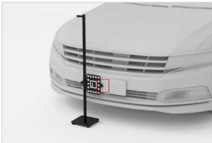
Figura 6-123 Coloque la ayuda de alineación
