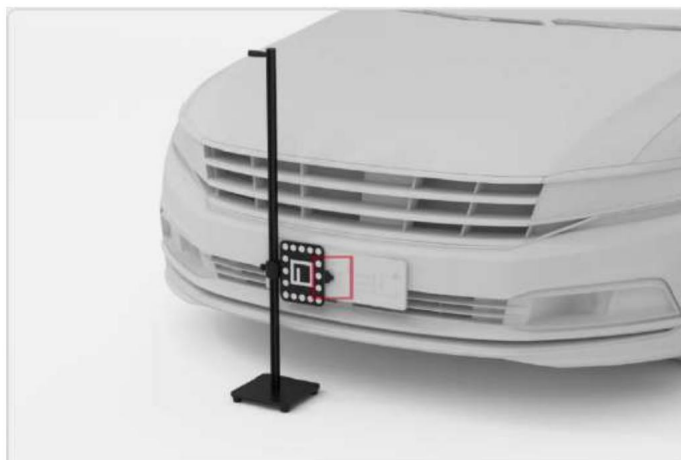
Figura 6-110 Coloque la ayuda de alineación
