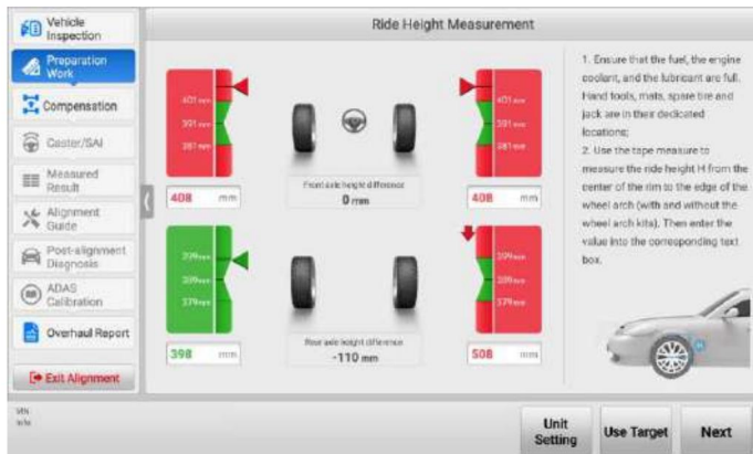
Figura 4-30 Medir la altura del vehículo con cinta 1
