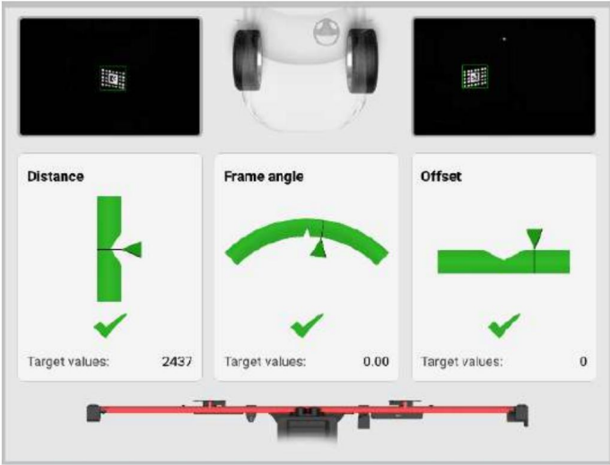
Figura 6-68 Ajuste del marco de calibración
