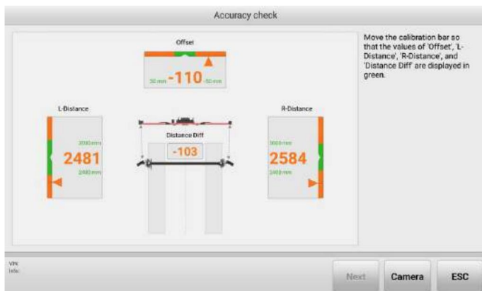
Figura 5-41 Pantalla de verificación de precisión (usar barra de calibración) 2
