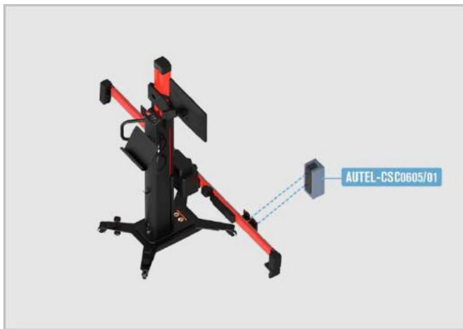
Figura 6-37 Instale la caja de calibración del radar en la placa deslizable derecha
