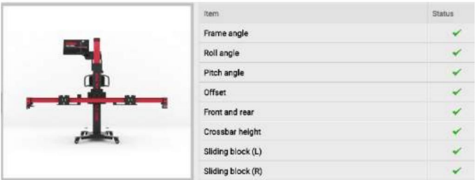
Figura 6-94 Posicionar automáticamente la barra transversal
